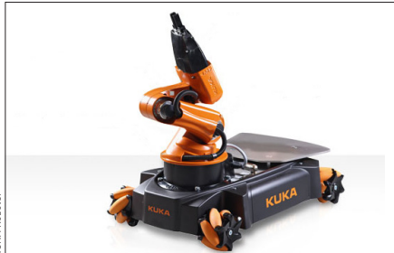
В процессе разработки мобильных манипуляторов компания KUKA создала робот Youbot с пятью степенями свободы
